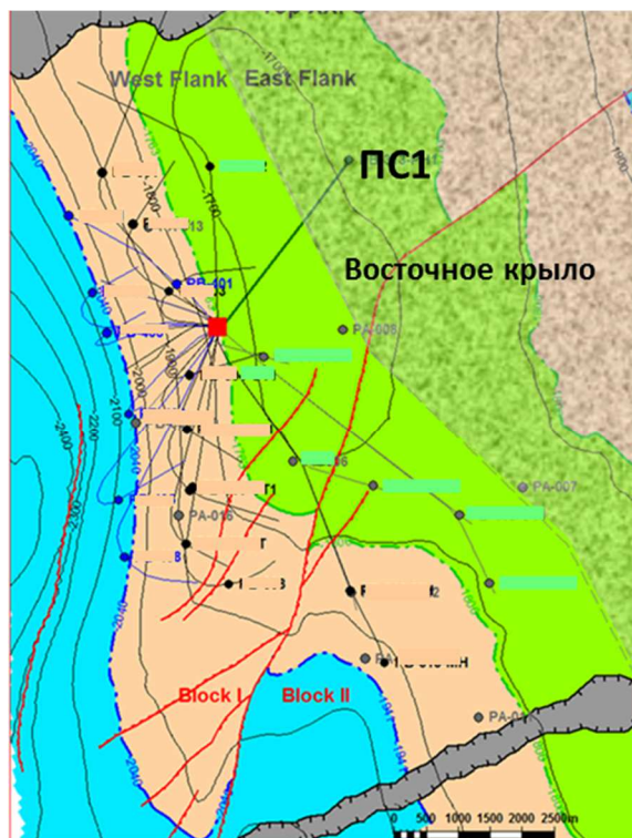
Рисунок 2 - Фактическая траектория ПС1 на структурной карте кровли пласта 42-С
