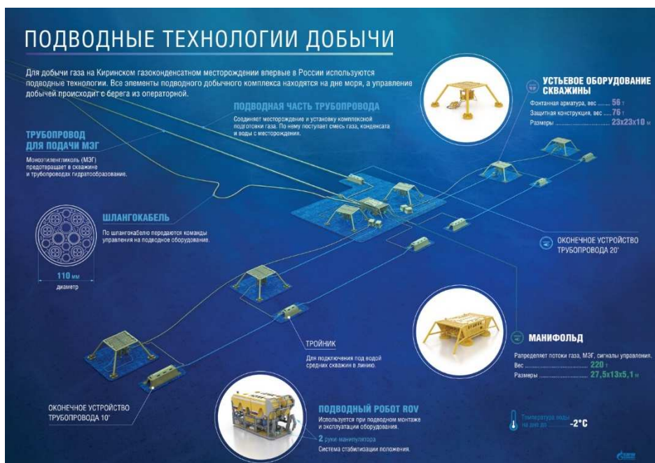
Рисунок 2. Схема подводного добычного комплекса (ПДК)
